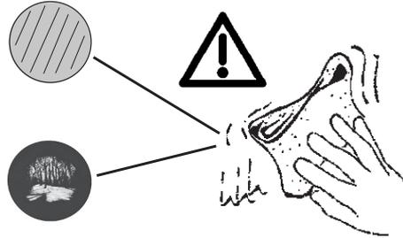
في عمليات التنظيف العادية ننصح باستعمال الماء أو المنظفات المحايدة ذات التركيبات المائية والغير كاشطة. لا تستعمل قطع القماش أو أدوات التنظيف الكاشطة لإزالة الوسخ.
