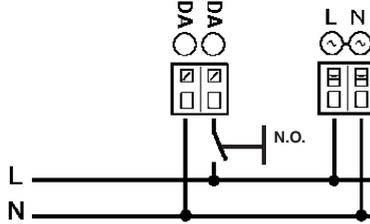
**IT** I dispositivi con cablaggio digitale possono essere dimmerati con dispositivi DALI o con pulsante normalmente aperto (N.O.) da collegare come da schema.
