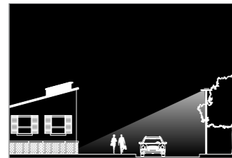
ST1.5U / Type III Short Optik für Wohngebietsstraßen und Fahrradwege, ideal für geringe Höhen
