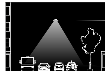
STWrW / Type I Medium Optik für hängende Montage in Strandrandgebieten mit Fahrzeugverkehr
