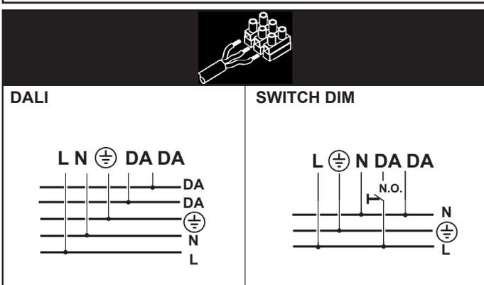
**IT** I dispositivi con cablaggio digitale possono essere dimmerati con dispositivi DALI o con pulsante normalmente aperto (N.O.) da collegare come da schema.
