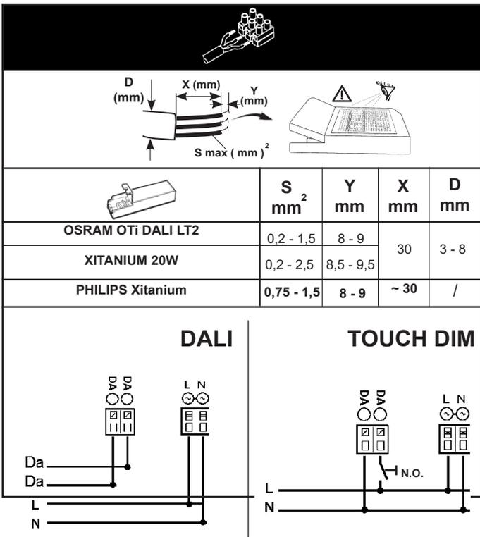
**IT** I dispositivi con cablaggio digitale possono essere dimmerati con dispositivi DALI o con pulsante normalmente aperto (N.O.) da collegare come da schema.
