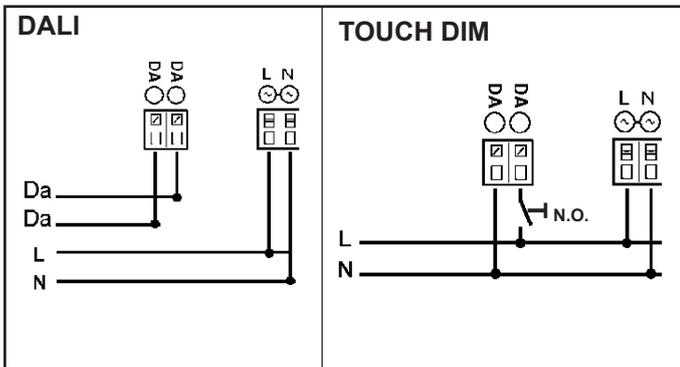
**IT** I dispositivi con cablaggio digitale possono essere dimmerati con dispositivi DALI o con pulsante normalmente aperto (N.O.) da collegare come da schema.
