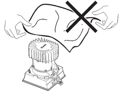
IT N.B.: Apparecchi non idonei ad essere coperti di materiale termicamente isolante
