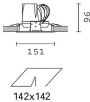
**Référence produit**MP16: appareil encastrable carré - LED dissipation passive Blanc Neutre - alimentation DALI intégrée - wide flood **Attention ! Code abandonné****Description technique**
