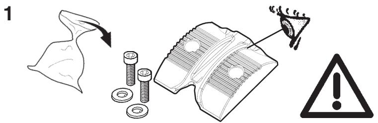
**I** Attenzione: durante l'installazione del vano ottico sul braccio, non utilizzare le viti M4X25 fornite con il prodotto ma quelle M8X40 fornite con questo braccio.
