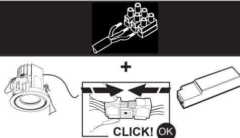
**IT** Cablare alla rete elettrica l'alimentatore solo dopo aver effettuato il collegamento ai prodotti
