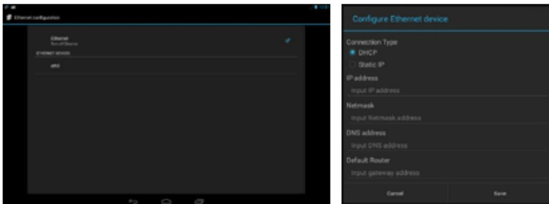
DHCP significa Dynamic Host Configuration Protocol e indica la possibilità di usufruire, quando disponibile, del servizio di configurazione della scheda di rete con IP dinamico. In questo modo il nostro computer può essere immediatamente utilizzato per l'accesso alla rete.
