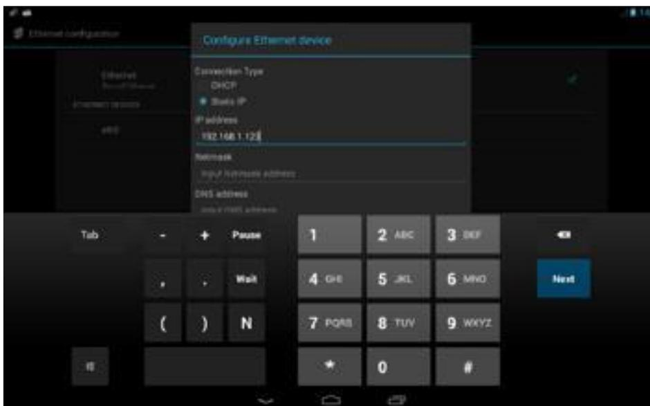
Con l'assegnazione di un indirizzo IP statico si rende necessari completare l'intera tabella di informazioni inserendo anche Netmask, DNS address e Default Router.
